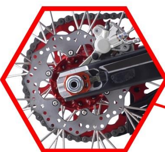
ТОРМОЗНОЙ ДИСК 220 ММ
