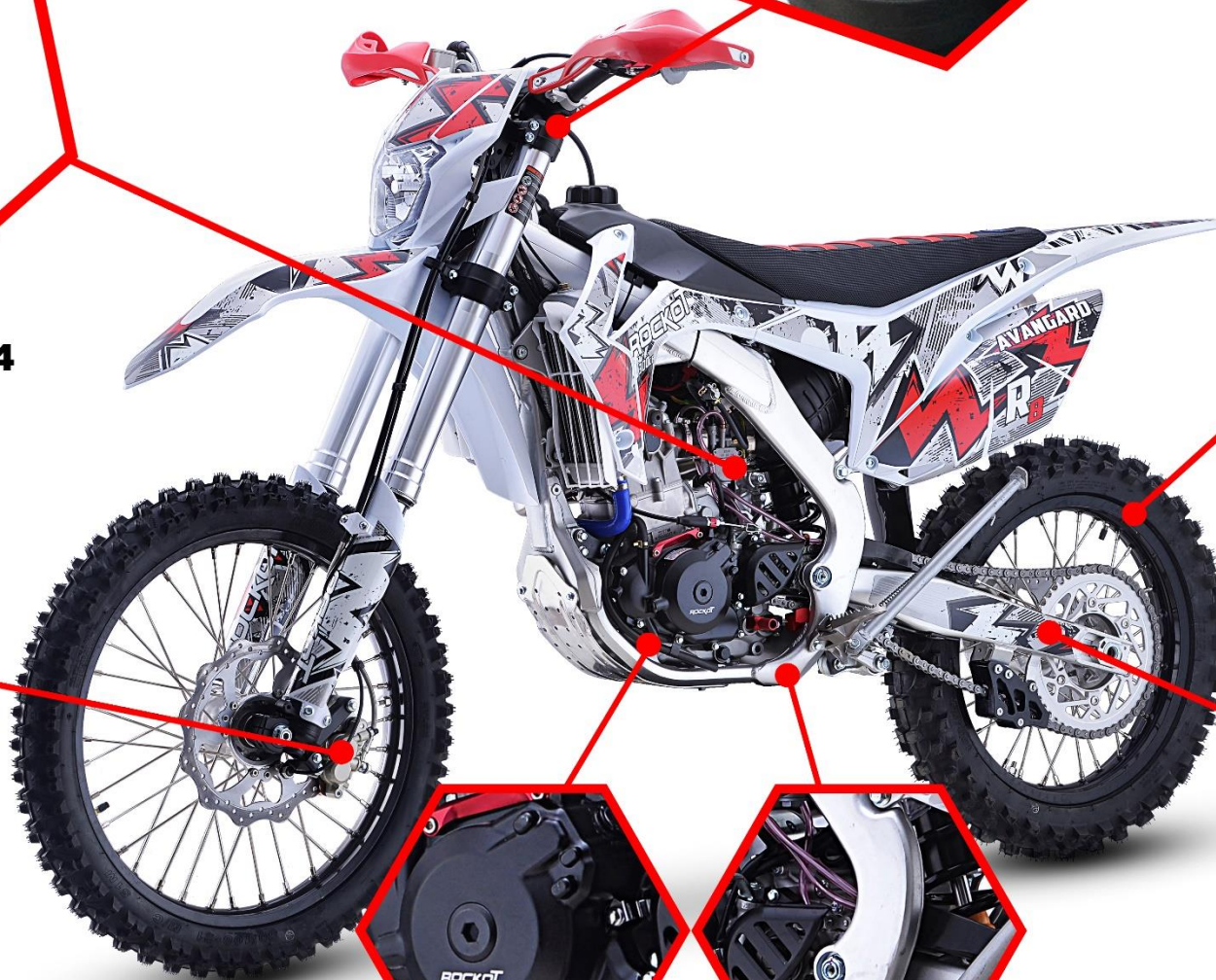
ДВИГАТЕЛЬ ZONGSHEN 4T 177MM С БАЛАНСИРНЫМ ВАЛОМ, ОБЪЕМОМ 298 см 3 АЛЮМИНИЕВАЯ СКЛАДНАЯ ЛАПКА КПП
