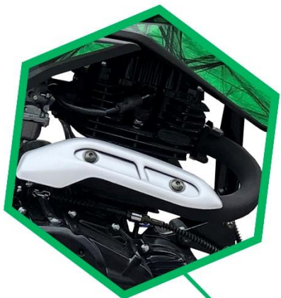
СТАЛЬНАЯ ВЫХЛОПНАЯ ТРУБА С ЗАЩИТОЙ
