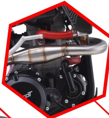
ВЫХЛОПНАЯ ТРУБА ИЗ НЕРЖАВЕЮЩЕЙ СТАЛИ С РЕЗОНАТОРОМ POWERBOMB
