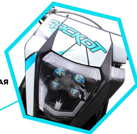
LED фара нового поколения с 4 линзами и диодным габаритом
