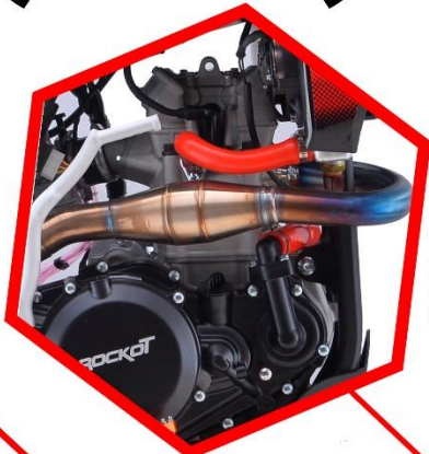
Выхлопная труба из нержавеющей стали с резонатором
