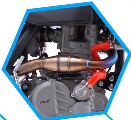
ВЫХЛОПНАЯ ТРУБА ИЗ НЕРЖАВЕЮЩЕЙ СТАЛИ С РЕЗОНАТОРОМ
