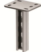
Подвес ПДД-21 (двойной, 41x21) Толщина профиля подвеса: 2,5 мм. Толщина пластины: 6 мм.
