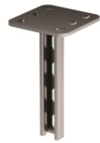
Подвес ПДО-21 (одиночный, 41x21) Толщина профиля подвеса: 2,5 мм. Толщина пластины: 6 мм.
